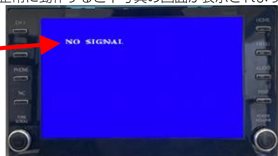
AV-HDM01本体電源投入 成功画面
