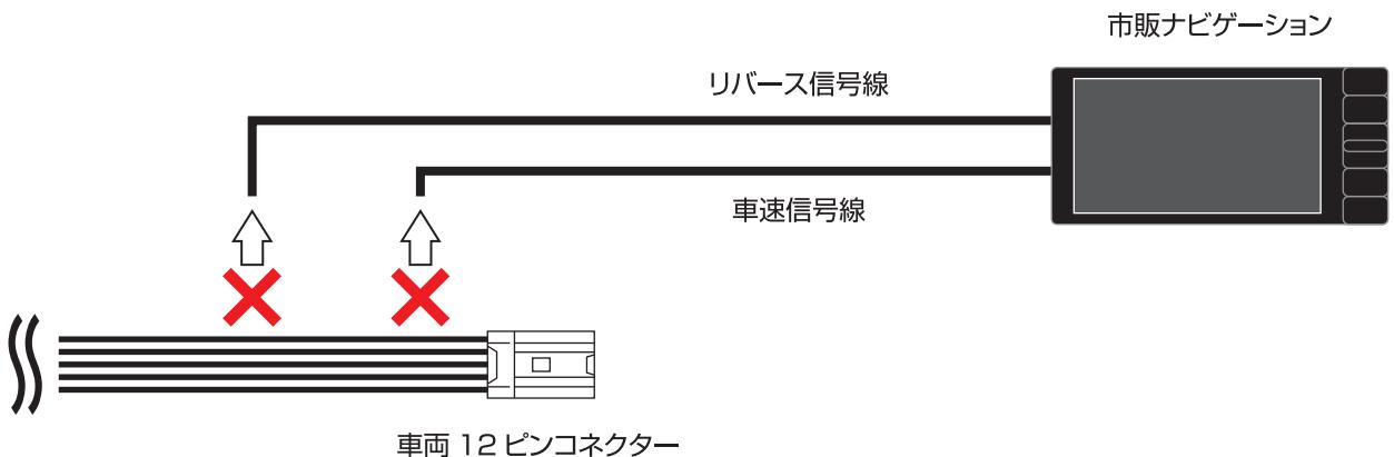
①ナビゲーションハーネスのリバース信号線と車速信号線に同梱のギボシ端子（オス）を使用し、本製品の紫線と桃線をそれぞれ接続します。
