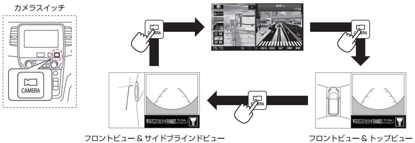
★車速が約 10km/h を超える又は約 3 分間操作が無い場合、 (カメラスイッチ) を押す前の画面（※）を表示します。
