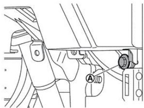
④右インストルメントロアパネルを図の 1→4 の順に矢印方向へ 引き、樹脂爪及びメタルクリップの勘合を外します。 ハーネスコネクター、ハーネスクリップ、及びデータリンクコ ネクターを外し、右インストルメントロアパネルを取り外します。
