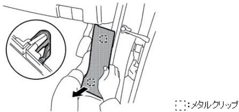
③フードロックコントロールハンドルを取り外し、取付ボルト A を 取り外します。
