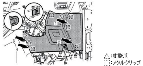
⑤取付クリップ A を外し、右フットダクト②を車両右側に押しながら、右フットダクト①を取り外し、その後に右フットダクト②を取り外します。
