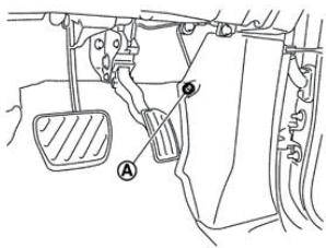
②ダッシュサイドフィニッシャを車両後方に引き、ダッシュサイド フィニッシャ取付メタルクリップの勘合を外し、ダッシュサイド フィニッシャを取り外します。
