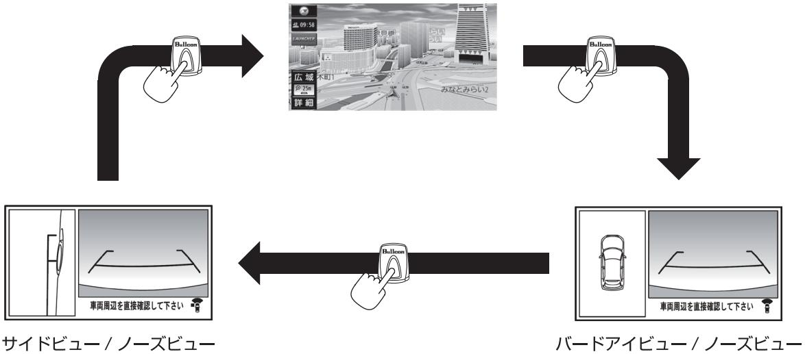
★約3分間スイッチ操作が無い場合や車速が約10km/hを超えた場合、スイッチを押す前の画面(※)を表示します。
