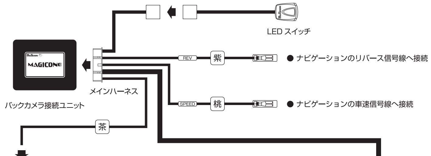
● 付属の分岐タップを使用し、車両のリバース信号線（下記図参照）へ接続。
