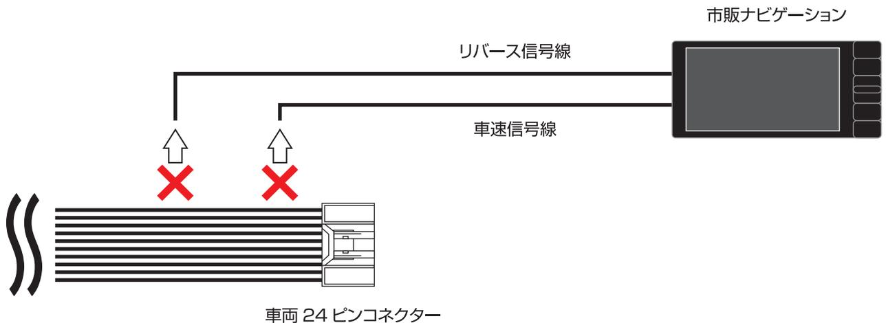
ギボシ端子（オス）を別途用意し、ナビゲーションハーネスのリバース信号線と車速信号線に本製品の紫線と桃線をそれぞれ接続します。
