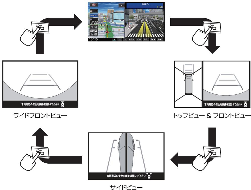
★約 3 分間スイッチ操作が無い場合や車速が約 10km/h を超えた場合、スイッチを押す前の画面（※）を表示します。
