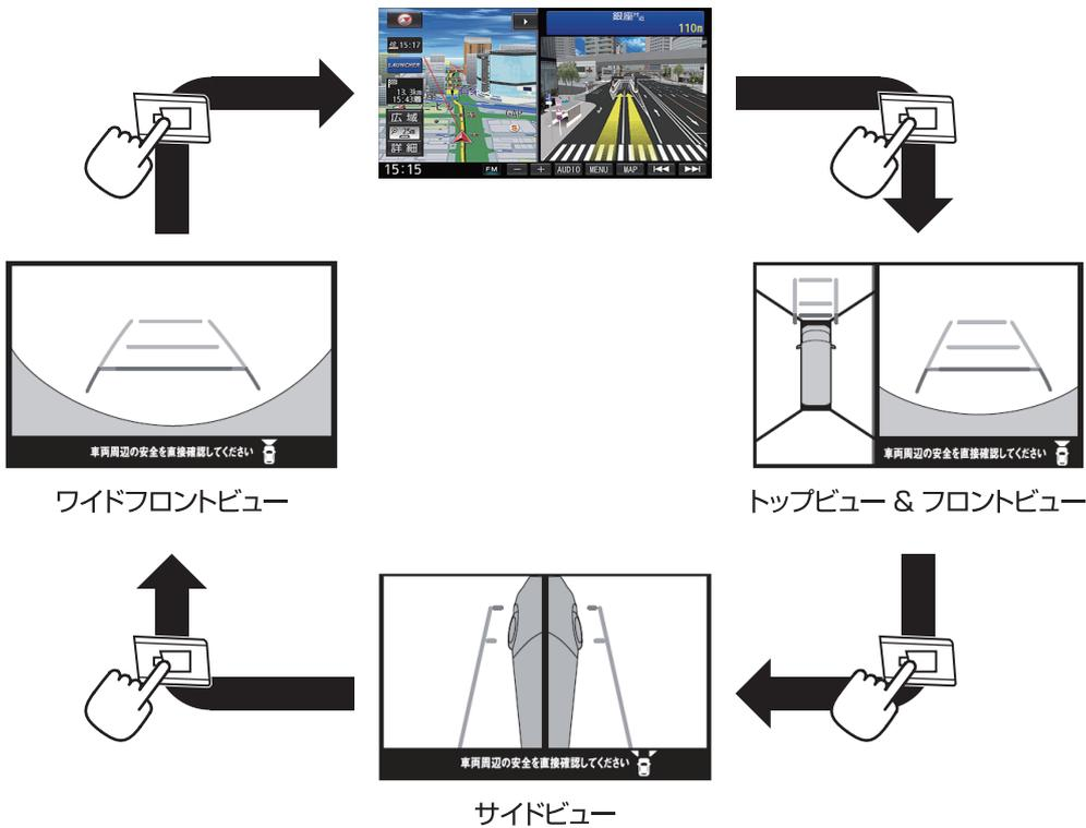
★約 3 分間スイッチ操作が無い場合や車速が約 10km/h を超えた場合、スイッチを押す前の画面（※）を表示します。
