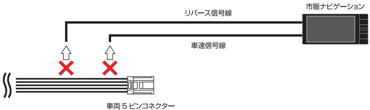
①ナビゲーションハーネスのリバース信号線と車速信号線に同梱のギボシ端子（オス）を使用し、本製品の紫線と水色線をそれぞれ接続します。
