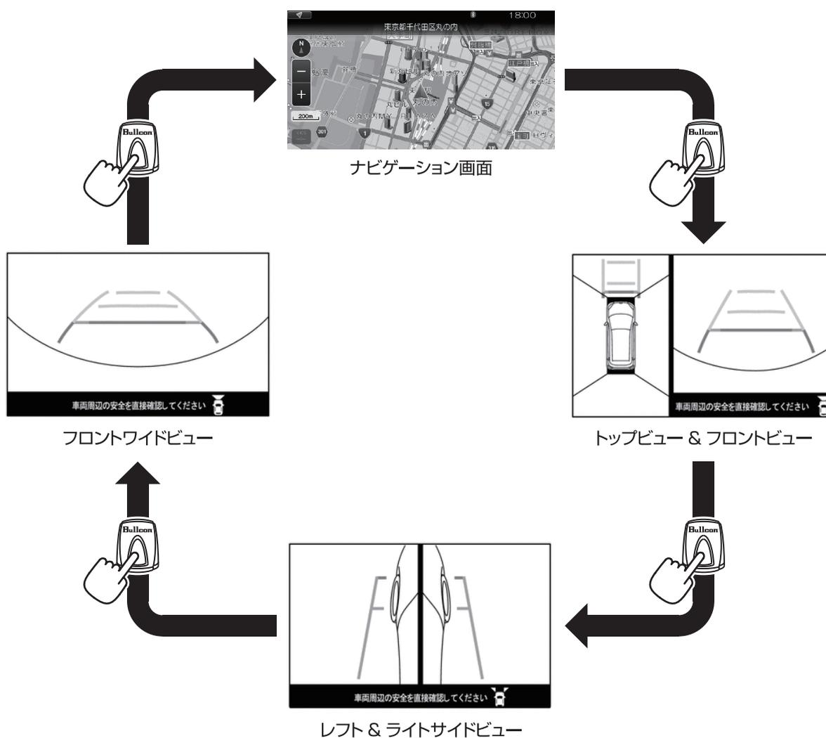
●車速が約 10km/h を超えた時又は、約 3 分間
