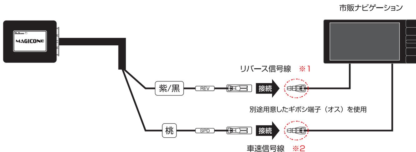
右図の様にナビゲーションハーネスのリバース信号線及び車速信号線を分岐して本製品に接続する事は絶対にしないでください。
