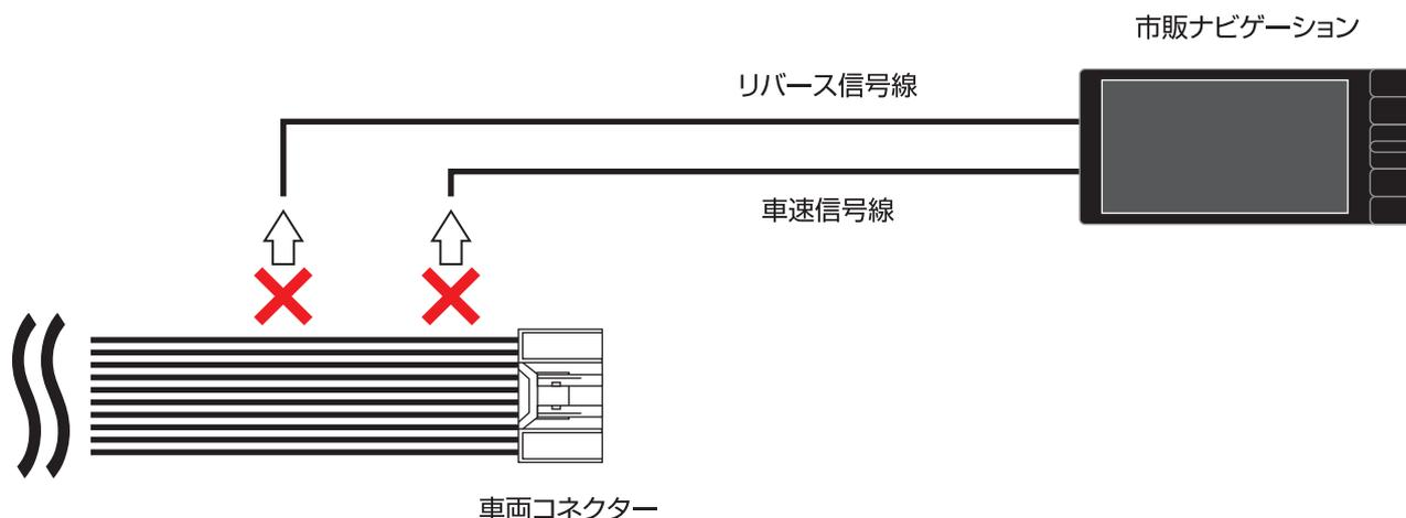
ギボシ端子（オス）を別途用意し、ナビゲーションハーネスのリバース信号線と車速信号線に本製品の紫 / 黒線と桃線をそれぞれ接続します。
