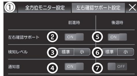
● IG-ON で[P]レンジ時、「3D ビュー映像」表示中に付属の
