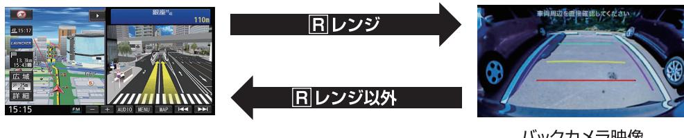
※カメラ機能によりバックカメラ映像にはガイド線（固定）が表示されます。（ガイド線は非表示にできません。）
