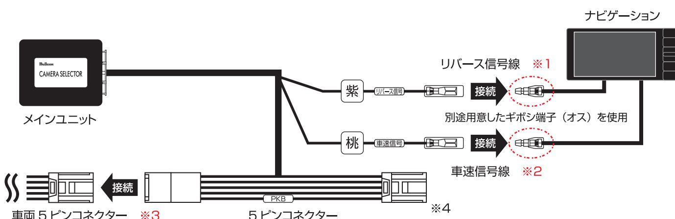
右図の様にナビゲーションハーネスのリバース信号線及び車速信号線を分岐して本製品に接続する事は絶対にしないでください。
