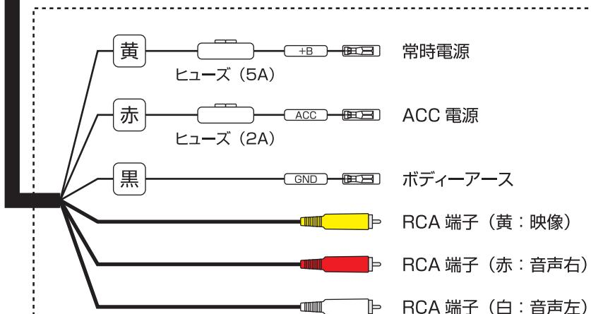
※常時電源・ACC 電源・ボディーアース・各 RCA 端子は接続機器以外には絶対に接続しないでください。
