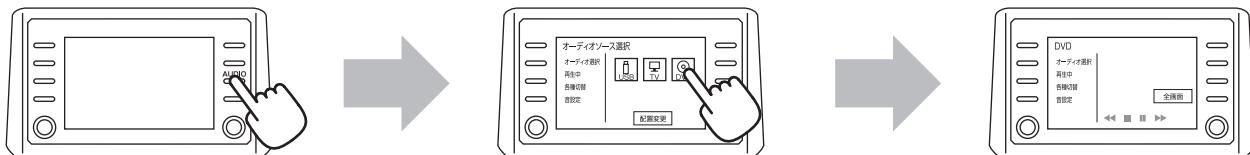
②本製品の LED スイッチを押し接続機器映像に切り替え、接続機器を再生してください。
