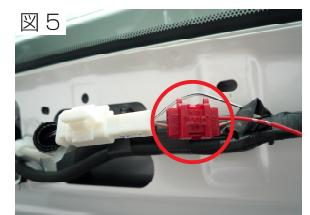
⑤ バックドアボディアースにメインユニットの黒線(図 6 参照)を接続します。接続後は、作業前に外したバッテリーのマイナス端子を確実に接続し動作確認を行います。
