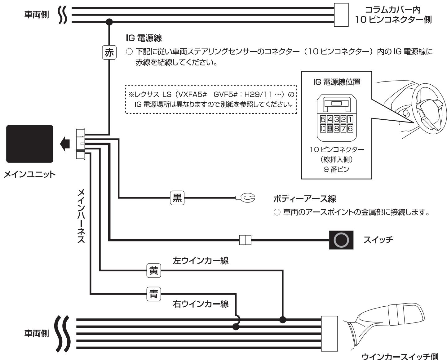
○ 下記に従い車両ウインカースイッチのコネクター（40ピンコネクター）の左ウインカーラインに黄線を、
