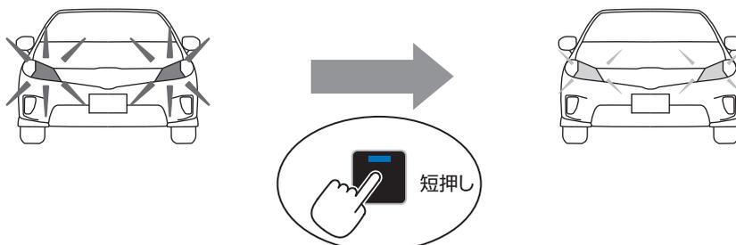
④ メンテナンスモード（IG-ON 後、サービスホールスイッチ C の LED4 回点滅→消灯）
