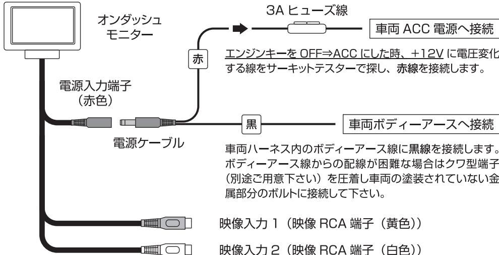
※付属の 3A ヒューズ線は電源ケーブルの赤線に必ず接続して下さい。
