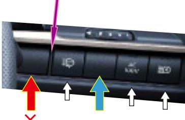
仕切り（紫矢印 →）よりもメーター側のサービスホール（赤矢印 →）はCタイプより一回り大きくなっているため、弊社製品のCタイプスイッチは設置できません。仕切りより外側の3連または4連のサービスホール（青矢印 → または白矢印 ⇛など）に設置してください。追加オプションにより青矢印および白矢印の箇所が埋まっている場合は、小型LEDスイッチタイプをお買い求めください。
