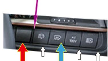
仕切り（紫矢印 →）よりもメーター側のサービスホール（赤矢印 →）はCタイプより一回り大きくなっているため、弊社製品のCタイプスイッチは設置できません。仕切りより外側の3連または4連のサービスホール（青矢印 → または白矢印 ⇛など）に設置してください。追加オプションにより青矢印および白矢印の箇所が埋まっている場合は、小型LEDスイッチタイプをお買い求めください。
