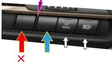
仕切り（紫矢印 →）よりもメーター側のサービスホール（赤矢印 →）はCタイプより一回り大きくなっているため、弊社製品のCタイプスイッチは設置できません。仕切りより外側の3連または4連のサービスホール（青矢印 → または白矢印 ⇛など）に設置してください。追加オプションにより青矢印および白矢印の箇所が埋まっている場合は、小型LEDスイッチタイプをお買い求めください。
