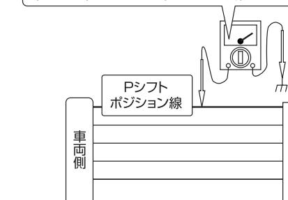
●車両のメーターパネル裏等からPポジション線をサーキットテスターで探し出します。制御によって配線が異なりますので必ずどちらか一方を配線して下さい。配線を間違えますと正常に動作しませんのでご注意下さい。
