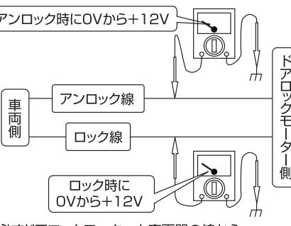
必ずドアロックモーターと車両間の線から配線を行って下さい。
