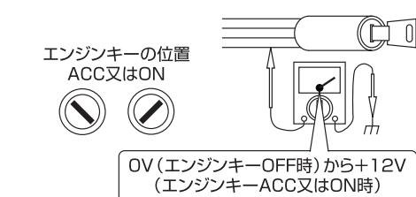
●車両のACC電源線 (エンジンキーの位置がOFF時にOV、ACC時に+12Vが出力している線)又は、IG電源線 (エンジンキーの位置がOFF時にOV、ON時に+12Vが出力している線)をサーキットテスターで探し出し、メインユニットの赤線を接続します。同じ様にリレーユニットの赤線と赤/白線も接続します。(リレーユニットの赤線と赤/白線は2本まとめて配線されても問題ありません。この場合、必ず末端をまとめて配線を行って下さい。)
