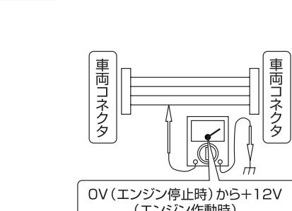
●車両のL端子線 (エンジンが停止している時にOV、エンジンが作動している時に+12Vが出力されている線)をサーキットテスターで探し出し、接続します。接続したドアアンロック線の車両側にリレーユニットの青/黒線を接続、ドアロックモーター側にリレーユニットの青/白線を接続します。
