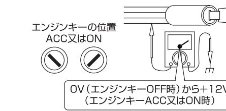
●日産車の場合、メインユニットの水線をACC電源線又はIG電源線に接続します。日産車以外は配線の必要がありませんので必ず絶縁処理を行って下さい。
