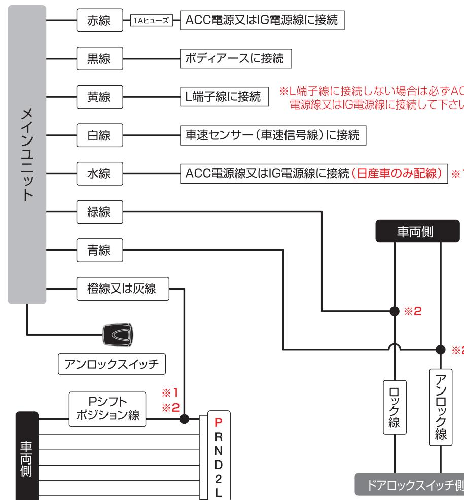
制御によって配線が異なります。シフトポジションをPレンジからPレンジ以外に変更した時、+12V→0Vならば橙線、0V→+12Vならば灰線を接続
