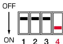
仮アンセット機能を無効(ディップスイッチ1番がONの状態)に設定している場合、不正アンロック警報機能が機能します。不正アンロック警報機能とはピッキング等で不正に開錠された場合、約30秒間の警報動作を行います。
