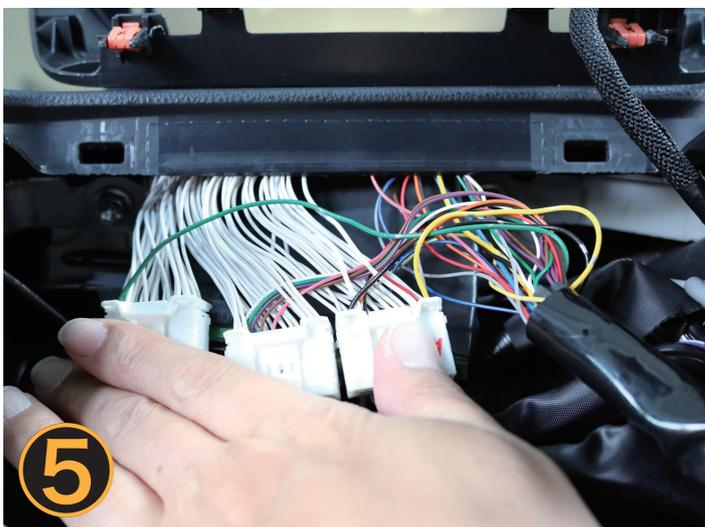
先ほどの隙間に製品の配線を押し込みながら、奥へ収納します。
