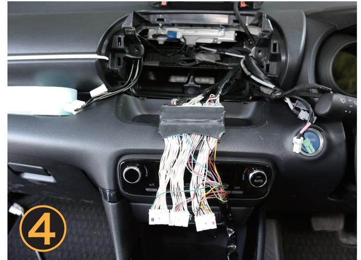
車両からの28ピン・30ピン・28ピンコネクタとAV-V05 Tを接続します。
