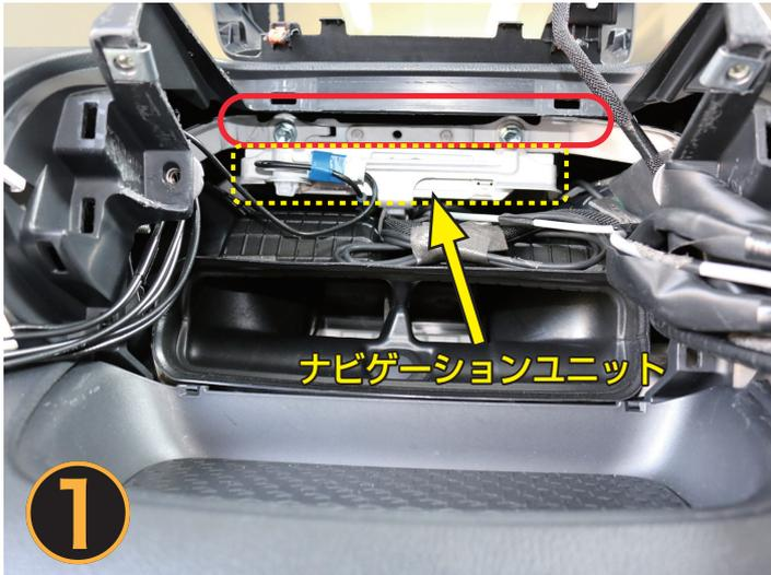
ディスプレイオーディオを外すと、ナビゲーションユニット（黄色破線枠内）とダッシュボードパネルの間に隙間（赤枠内）があります
